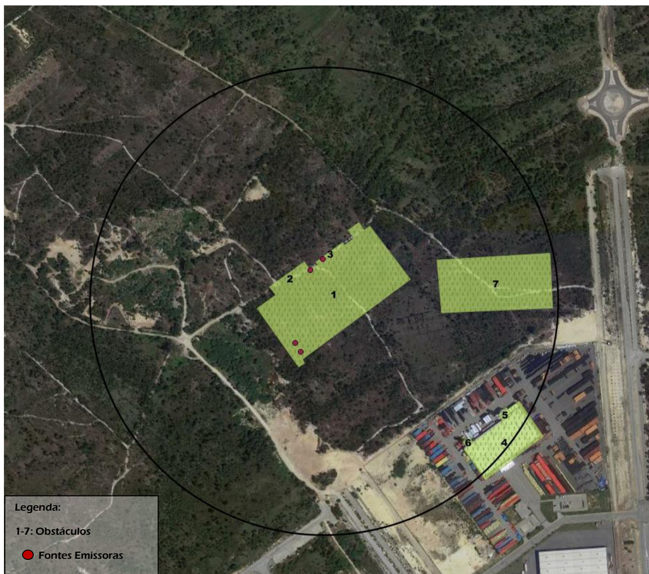
Figura III-1 – Apresentação dos obstáculos inseridos no raio de 300 metros, a partir das fontes da EUROCAST, incluindo os edifícios da própria instalação (Imagem do Google Earth ).
